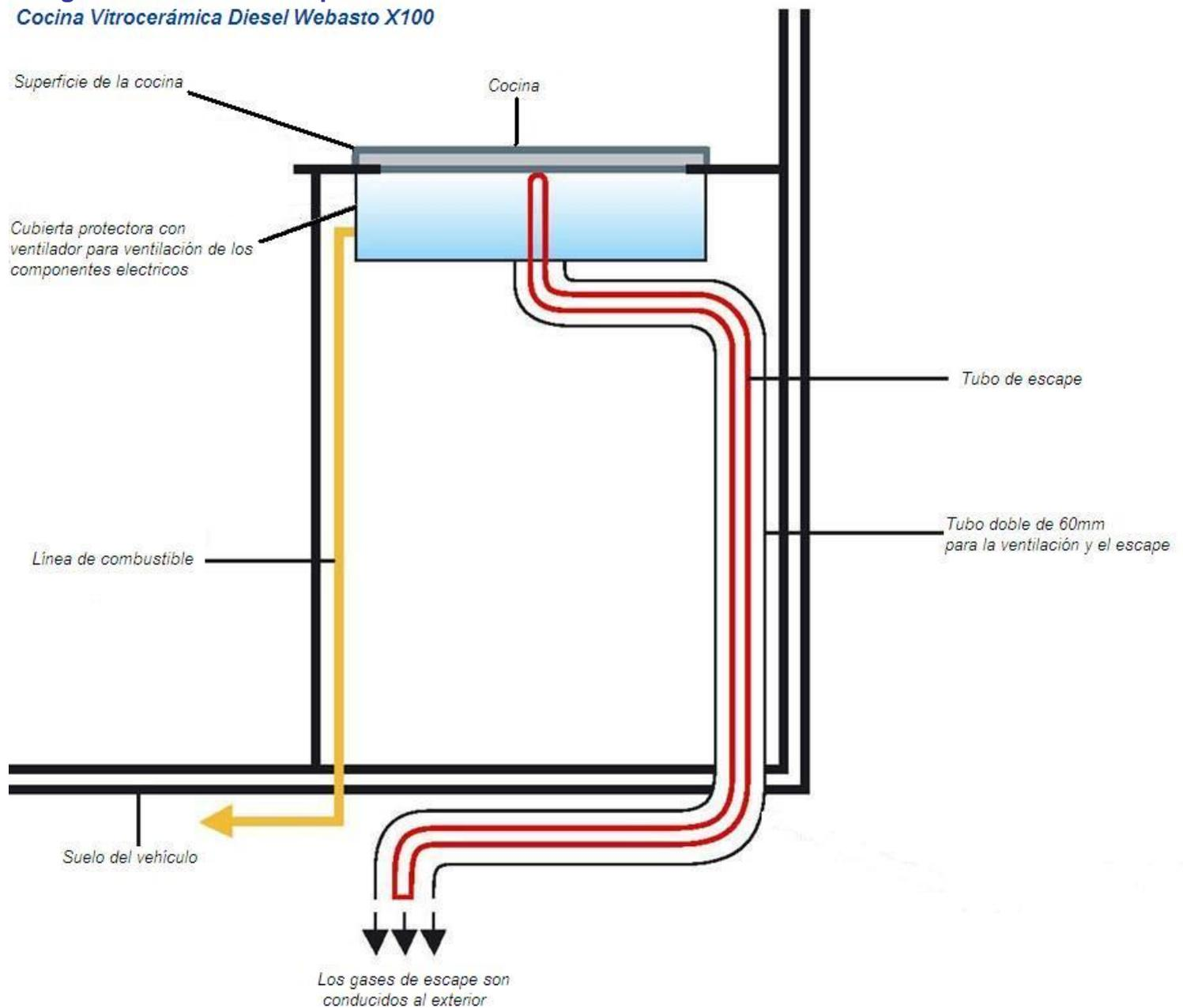
La cocina puede ser instalada sin dificultad en casi todos los modelos de vehículos. Se instala empotrada en la superficie de la encimera. Una carcasa metálica instalada bajo la placa vitrocerámica a modo de cubierta protectora protege todos los componentes, además de integrar un ventilador que asegura que todo el calor producido dentro del mueble sea canalizado desde la parte inferior de la cocina al exterior vía un tubo flexible coaxial.
